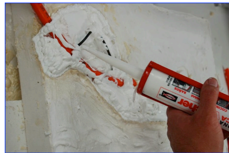
1. Rellenado del molde con silicona y poliespán
